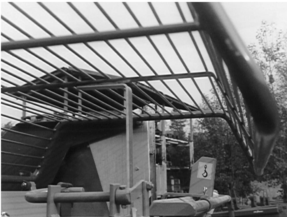
**Kuva 45.** Nivelakseli tuettuna koukkuun, kun kone on irrotettu traktorista.
