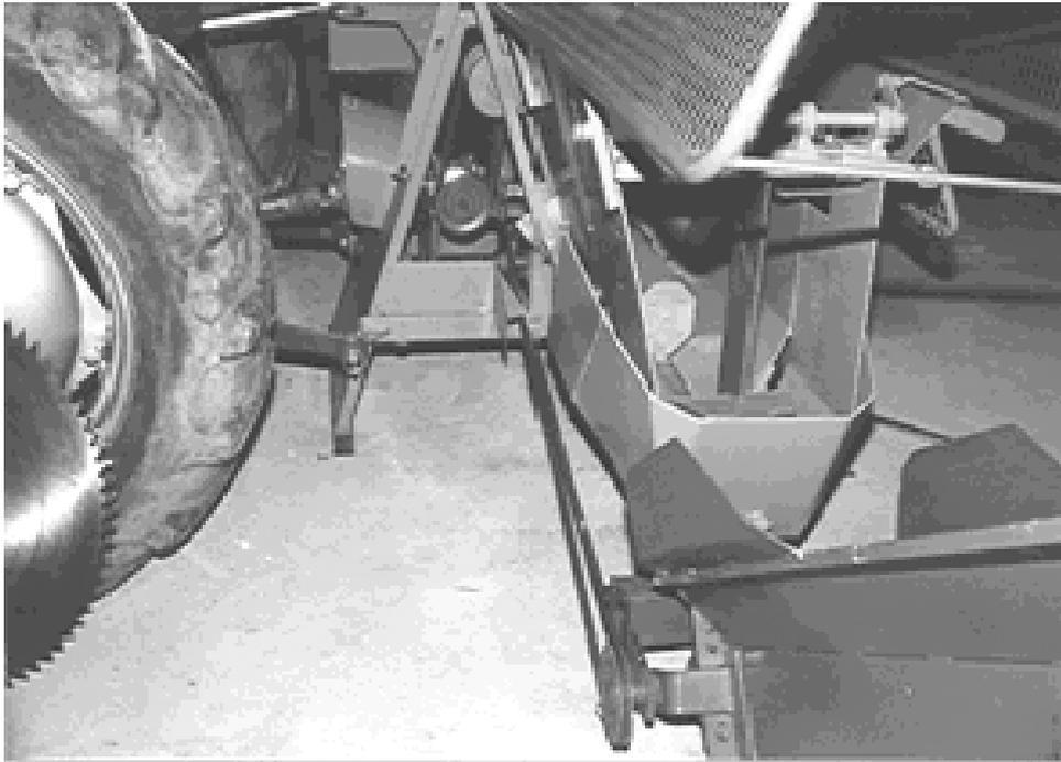
**Kuva 33.** Kuljettimen kiilahihnasuoja
