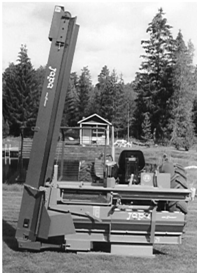
**Kuva 27.** Kuljettimen kiinnitys pystyasentoon
