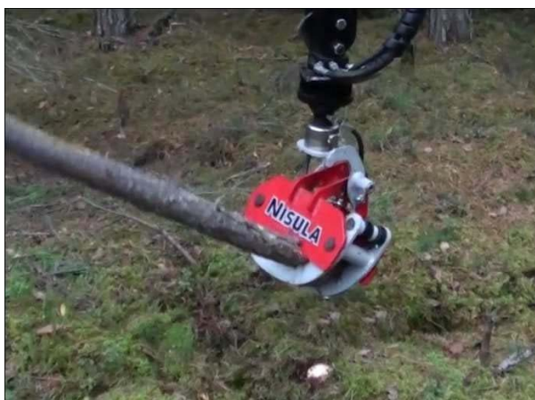
7. Vippen blir løst ut og treet starter å falle under klippeoperasjonen.
