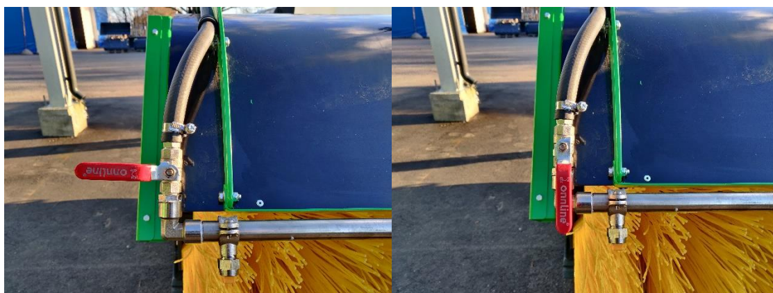
Figur 6. Kulekran i lukket stilling til høyre og åpen til venstre
