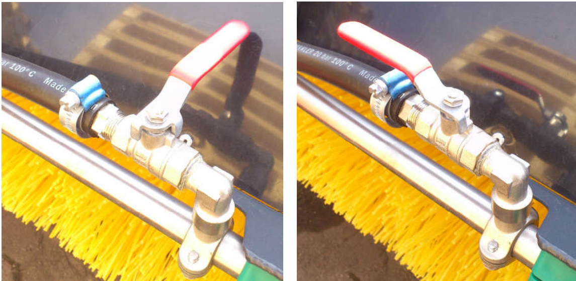
Figur 6. Kulekran i lukket stilling til høyre og åpen til venstre
