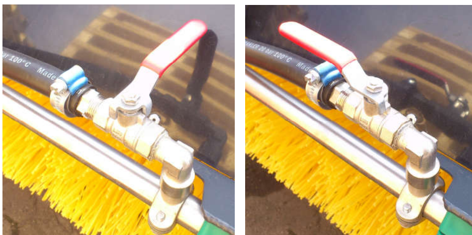
Figur 5. Kulekran i lukket stilling til høyre og åpen til venstre
