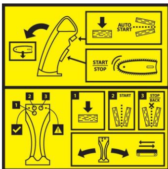
Styring av kapping, innmatingstransportør sideskyving og kløving.
