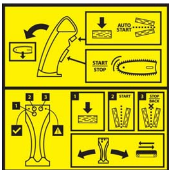
Kontroll av innmatingstransportør, kutting, hylle og kløyving.
