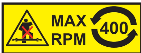
Se opp for den roterende akselen! Maksimalt tillatt rotasjonshastighet og retning på kraftuttaksakselen.
