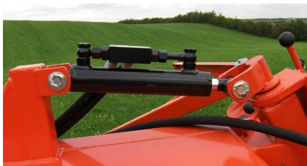
Figur 19: Maskinen hældes fremover ved hjælp af cylinder (42411).
