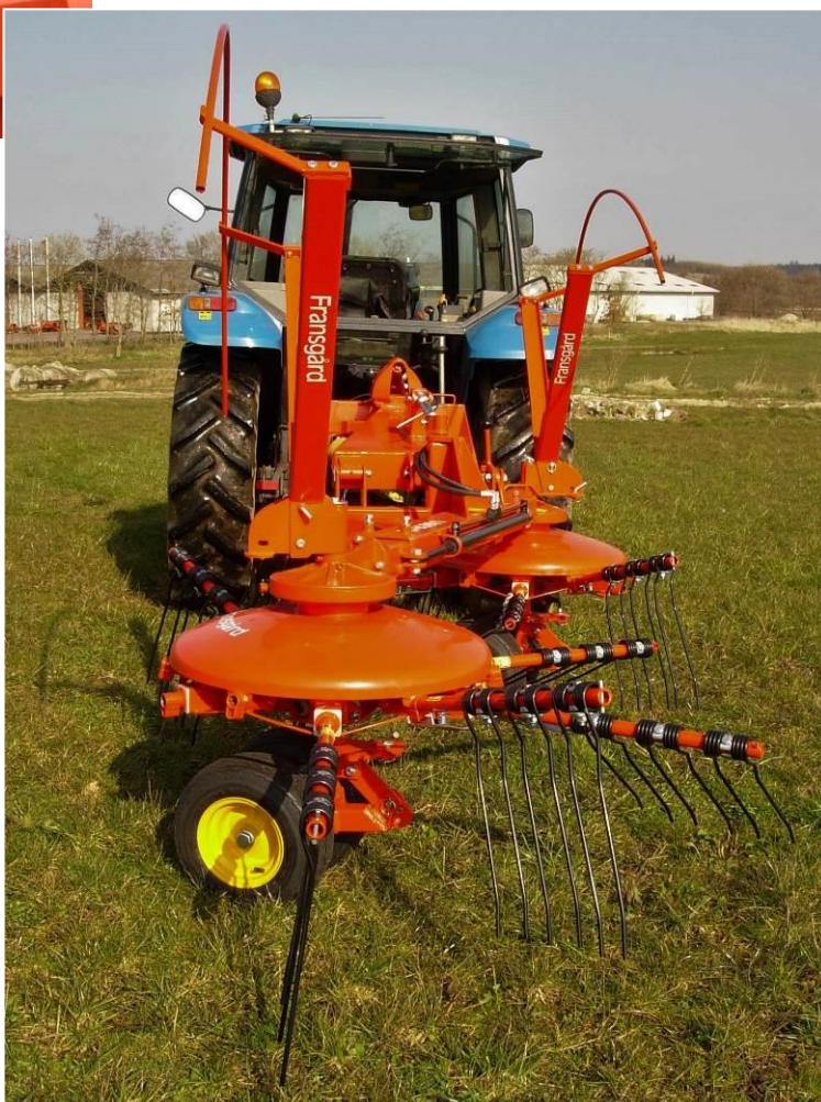
Figur 21: Maskinen er omstillet til transportstilling.
