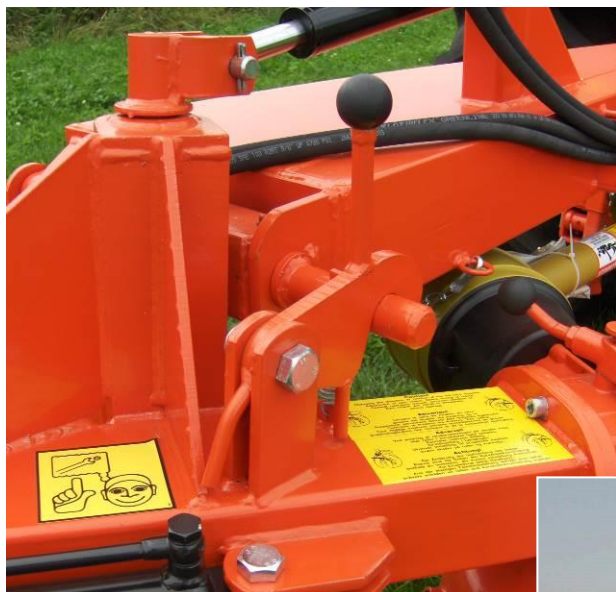
Figur 20: Låsepal (42439) går i indgreb, således maskinen er låst i transportstilling.
