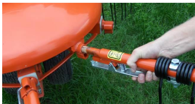
Figur 18: Rivearmene monteres i fast arbejdsposition.
