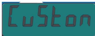
Unità di misura". Il contalitri una volta confermato con
