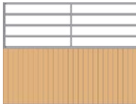
8. Klämmestorp mellanvägg med liggande rör.
