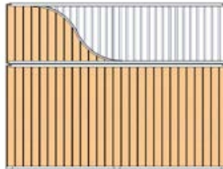
4. Färömmellanvägg med 2 m kontaktgaller.
