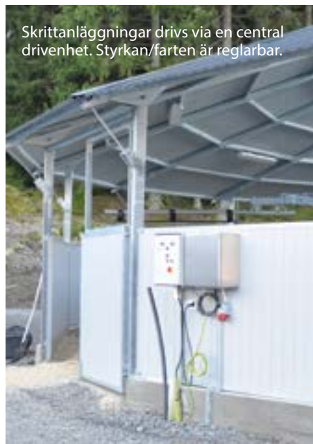
Skrittmaskiner för den lilla eller stora anläggningen. Från 4-8 hästar. Det finns skrittmaskiner med dimensionerna om; 16,18 och 20 meter i diameter. Skrittmaskinen bultas på gjutna plintar eller betongplatta. Går att få med eller utan tak.
