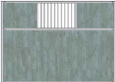
5. Tät mellanvägg med 1 m rakt kontaktgaller.
